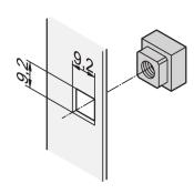
Квадратные гайки имеют более высокую контактную поверхность и не скругляются, в отличие от шестигранных гаек. Для точного, предотвращающего раскручивание, надежного крепления без зазоров используйте квадратные гайки.
