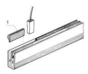
Защита шины от прикосновения для электроизоляции.
