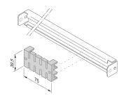
С-образные рельсы предназначены для более эффективной организации кабелей. Обычно рельсы монтируются на задней части 19-дюймовых рельсов. Совместимы со стандартными кабельными зажимами.
