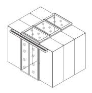
Сплошные панели для различных высот изолированных коридоров предотвращают утечку воздуха в коридорах.
