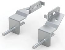
Para montar duas placas de montagem com as partes posteriores encostadas a qualquer profundidade dentro do espaço utilizável do armário, a posição pode ser ajustada em incrementos de 25 mm. O espaço entre as placas de montagem é inferior a 10 mm, o que maximiza o espaço que pode ser utilizado pelo cliente.
