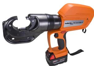
A ferramenta de engaste nVent ILSCO TaskMaster com punho de pistola de 12 toneladas (130 kN) é uma ferramenta de engaste que pode ser utilizada com a linha de conectores de ligação à terra de compressão nVent ERICO. Os engastes em C e em E são compatíveis com esta ferramenta, para além das matrizes nVent ILSCO.
