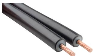
O condutor isolado de descida ISO<sub>n</sub>V é um cabo de descida especializado para proteção contra descarga atmosférica que, durante a operação, pode ficar sujeito a correntes de impulso de até 200 kA. O ISO<sub>n</sub>V foi projetado e testado para controlar a distância de separação e o arco. Uma camada externa semicondutora é usada para minimizar os gradientes de tensão sob condições de descarga atmosférica.
