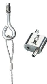
O sistema de iluminação nVent CADDY Speed Link com bucha de fixação inclui um comprimento pré-cortado (1m e 2m) de cabo de aço de 1mm, rebitado a uma bucha de fixação, juntamente com um dispositivo de bloqueio de perfil ultrabaixo. Os empreiteiros podem instalá-lo de forma rápida e segura em tetos de betão para suportar e fixar iluminações e sinalética.
