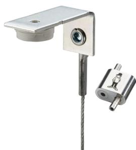
O sistema de iluminação nVent CADDY Speed Link com suporte para pistola de pregos inclui um comprimento pré-cortado (1m e 2m) de cabo de aço de 1mm, rebitado a um suporte angular concebido para fixação direta, juntamente com um dispositivo de bloqueio de perfil ultrafino. Os empreiteiros podem instalá-lo de forma rápida e segura em tetos de betão utilizando uma vasta gama de pistolas de pregos para suportar e fixar iluminações e sinalética.
