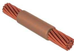
Conexões para serviço pesado foram originalmente desenvolvidas para serem usadas em cabo recuperado. Conexões para serviço pesado usam uma cavidade de conexão de tamanho maior no molde e um material de soldagem de tamanho maior do que a conexão equivalente do serviço padrão para a carga.
