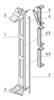
Pannello frontale a U con fessura per PMC. Schermabile per guarnizione EMC in tessuto.
