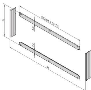
Il montaggio del telaio anteriore fornisce il contatto tra i sottorack e i complessivi. Deve essere utilizzato se un cliente ha scelto un kit di montaggio su scheda orizzontale.
