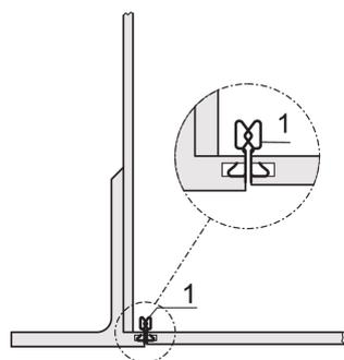
Per schermatura EMC verticale in acciaio inox tra i pannelli frontali schermati montati incassati e il pannello laterale.
