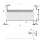
Il pannello posteriore perforato, al, 2,5 mm, non è schermato. Il lato posteriore è conduttivo.
