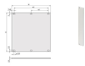
Pannello anteriore, non schermato, anodizzato anteriore e conduttivo posteriore.
