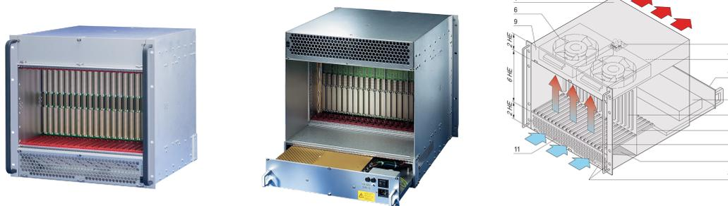
Sistema VME64 per 21 schede VME64x 6 U, 160 mm. Opzione i/o posteriore l'alimentazione per il sistema è fornita da un alimentatore a telaio aperto. Un modulo di comando ventola monitora le ventole, la temperatura e la tensione.
