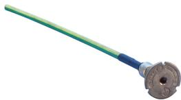
I ponti di messa a terra sono assemblaggi composti da un punto di contatto con la terra conduttivo ad alta qualità (terminale di connessione) e vari tipi di conduttori. Il processo di connessione esotermica nVent ERICO Cadweld è utilizzato per combinarli insieme, formando un assemblaggio di lunga durata e altamente resistente alla corrosione.
