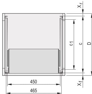
Guide telescopiche con profilo di guida per il montaggio in armadi con capacità di carico di 25 kg.
