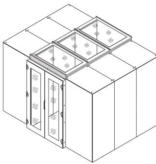
Le porte a battente sono le soluzioni di chiusura economiche più utilizzate nei sistemi di contenimento delle corsie.
