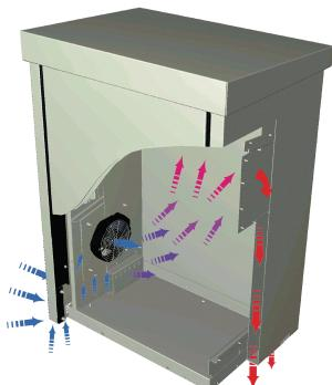
Ventola per la dissipazione del calore forzato 35 W/K..
