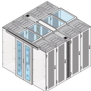
Coperchio superiore a diverse profondità per impostare una chiusura di contenimento della corsia.
