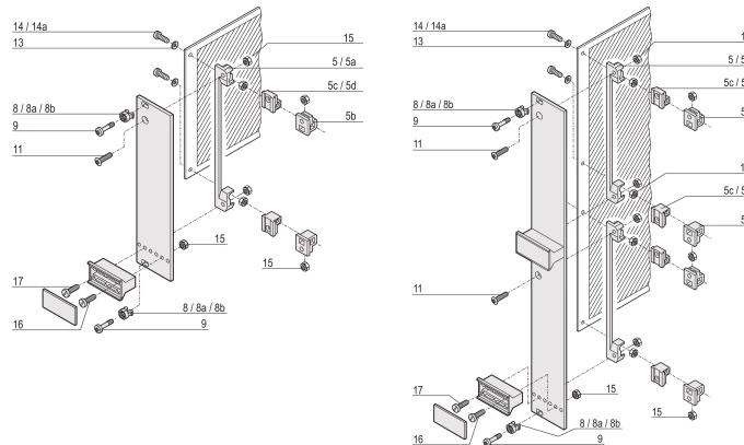
Vite a testa cilindrica, Pozidrive.
