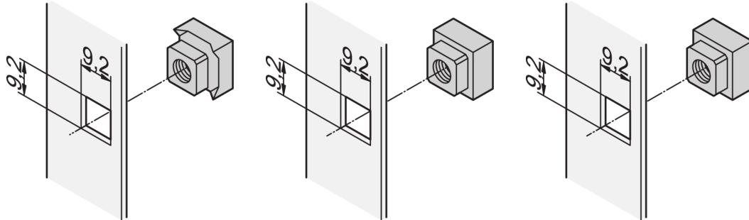
I dadi quadrati hanno una superficie di contatto più alta e non vengono arrotondati a differenza dei dadi esagonali. Per un montaggio sicuro e preciso, anti-torsione senza gioco, utilizzare dadi quadrati.
