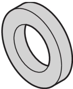
Rondella utilizzata per il fissaggio del circuito stampato.
