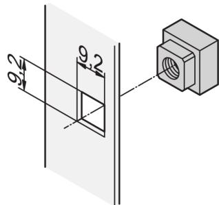
I dadi quadrati hanno una superficie di contatto più alta e non vengono arrotondati a differenza dei dadi esagonali. Per un montaggio sicuro e preciso, anti-torsione senza gioco, utilizzare dadi quadrati.
