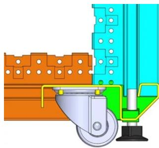
Telaio in acciaio saldato Varistar per requisiti di carico statico. Per l'integrazione di 19", ETSI o piastra di montaggio. Per applicazioni mobili.
