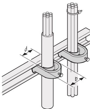
Le guide a C consentono una migliore gestione dei cavi. Installazione generalmente dietro i montanti da 19". Sono compatibili con i fermi per cavi standard.
