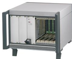
Custodia da tavolo TVPX per 5 schede VPX 3 U, 160 mm. Con o senza opzione i/o posteriore l'alimentazione per il sistema è fornita da un alimentatore a telaio aperto collegabile.
