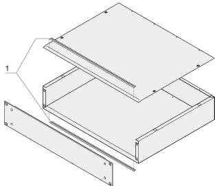
Il kit di schermatura EMC e le piastre di copertura aumentano la schermatura del telaio da circa 30 dB(A) a circa 60 dB(A). È possibile scaricare un rapporto di prova.
