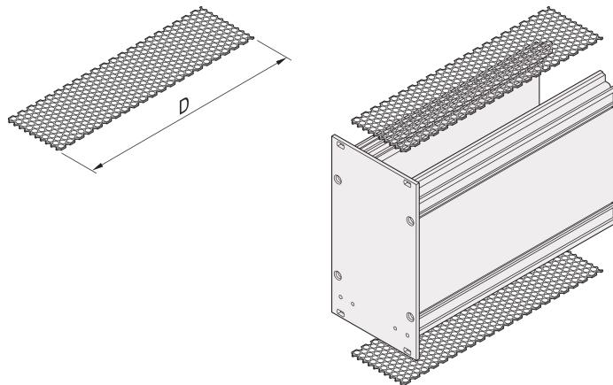
La piastra di copertura per le unità a innesto del tipo a telaio, con perforazione garantisce una portata d'aria di circa il 65%. La piastra è inserita in una scanalatura del pannello laterale.
