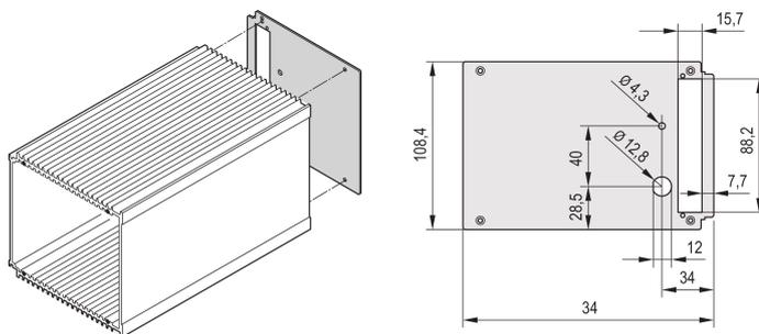
Pannello posteriore per unità a innesto tipo telaio HF, con foratura per un connettore, che consente all'utente di assemblare un connettore. Conforme alla norma EN 60603-2.
