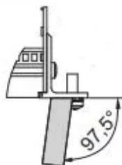
Sottorack schermato non EMC per il montaggio su backplane, versione pesante con pannelli laterali saldati e maniglia anteriore.
