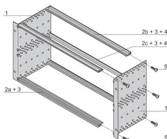
Sottorack schermato non EMC per il montaggio su backplane, versione leggera.
