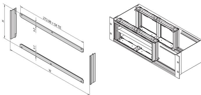
Il montaggio del telaio anteriore fornisce il contatto tra i sottorack e i complessivi. Deve essere utilizzato se un cliente ha scelto un kit di montaggio su scheda orizzontale.
