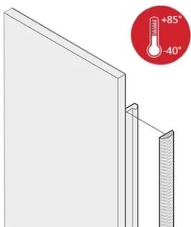
Le guarnizioni EMC in tessuto sono inserite in una fessura sul lato destro dei pannelli anteriori a U. Le guarnizioni sono incollate al pannello anteriore. Per un intervallo di temperatura esteso fino a +85°C..
