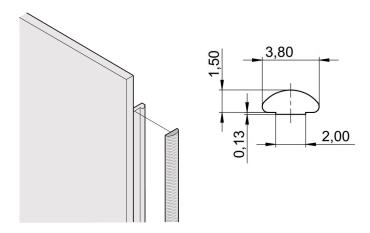
Le guarnizioni EMC in tessuto sono inserite in una fessura sul lato destro dei pannelli anteriori a U. Le guarnizioni sono incollate al pannello anteriore.
