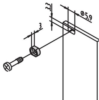
Il manicotto guida la vite a collare durante il fissaggio del pannello anteriore.
