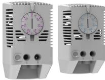
Questo termostato a temperatura regolabile, ETR, per qualsiasi armadio o cassa, con contatto normalmente aperto (NA) o normalmente chiuso (NC), viene utilizzato per controllare i dispositivi installati. Tali dispositivi, che potrebbero essere una ventola con filtro o un riscaldatore ventilato, devono attivarsi o disattivarsi al livello di temperatura richiesto, impostato dall'utente. Il risultato è una riduzione dei costi di esercizio.
