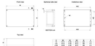
La gamma di cassette di derivazione in poliestere, MGRP, con grado di protezione IP 66, 67, è disponibile sul mercato in molti formati diversi. La gamma MGRP è adatta ad ambienti indoor e outdoor grazie all'elevata resistenza alla corrosione e ai raggi UV. Poiché acqua e polvere non possono penetrare all'interno della cassetta di derivazione, il rischio di guasto dei componenti è eliminato e, con esso, gli inutili tempi di inattività.
