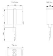
Questo piccolo riscaldatore anticondensa, EGK, è disponibile con una gamma della capacità di riscaldamento di 10-30 W. La dimensione ridotta lo rende adatto anche in spazi ristretti. Il fenomeno della condensazione dell'acqua è eliminato, anche quando la temperatura ambiente scende bruscamente. Per la versione UL, contattare nVent HOFFMAN.
