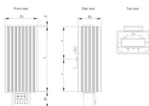
Questo riscaldatore anticondensa, EHG, è disponibile con una gamma della capacità di riscaldamento di 15-150 W. L'ampia gamma permette di scegliere in modo semplice il riscaldatore ottimale anche quando lo spazio all'interno dell'armadio è ristretto. Il fenomeno della condensazione dell'acqua è eliminato, anche quando la temperatura ambiente scende bruscamente.
