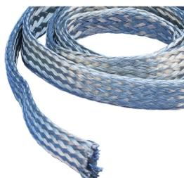
L'uso primario di una treccia tubolare è fornire ai cavi sensibili uno schermo EMC/EMI per proteggerli da interferenze elettromagnetiche, elettrostatiche e a radiofrequenza. Le prestazioni ottimali di protezione vengono ottenute usando trecce in filo di rame che possono essere usate anche per scopi di continuità di messa a terra.
