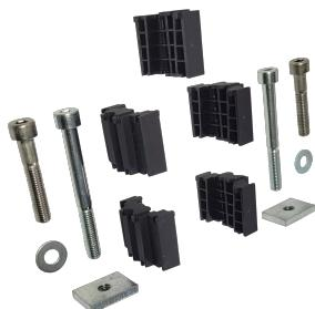
Kit per elevate correnti di cortocircuito progettato per far sì che l'nVent ERIFLEX IFBS possa sopportare elevati valori di cortocircuito fino a 130 kA di picco. Questo kit include due dadi per profilo strut, due viti a testa CHC M8 (75 mm), due viti a testa CHC M8 (40 mm) e cinque distanziali rinforzati.
