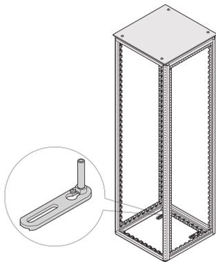
La protezione antiribaltamento contribuisce a rendere stabili i contenitori montati a pavimento e impedisce il ribaltamento a causa dell'imbollanza del carico. La protezione antiribaltamento può essere montata sul telaio o sulla base.
