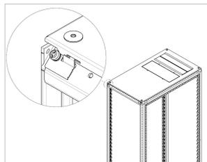
Il fermo interno può essere facilmente montato senza forare e consente di rimuovere il coperchio superiore solo dall'interno. Il fermo è solo per applicazioni IP 20.
