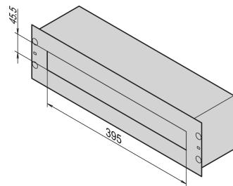
La scatola di distribuzione viene utilizzata per alloggiare PDU che distribuiscono in modo sicuro l'elettricità dalla fonte di alimentazione ai dispositivi di un circuito.
