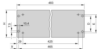
Definire le parti anteriori e laterali del dispositivo con i pannelli anteriori Schroff da 19". I pannelli frontal Schröff da 19" sono dotati di fori aggiuntivi per il montaggio delle maniglie e sono disponibili in versioni da 1 U a 6 U.
