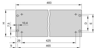
Definire le parti anteriori e laterali del dispositivo con i pannelli anteriori Schroff da 19". I pannelli frontal Schröff da 19" sono dotati di fori aggiuntivi per il montaggio delle maniglie e sono disponibili in versioni da 1 U a 6 U.
