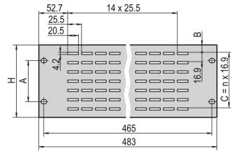
I pannelli anteriori ventilati consentono la dissipazione del calore attraverso i fori.
