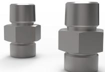
Questo adattatore per tubazioni è un raccordo maschio-maschio con filettatura di tenuta piatta BSPP da 1" su un'estremità e NPT da 1" sull'altra. Adatta i tubi flessibili BSP da 1" per l'installazione in impianti di acqua refrigerata NPT di tipo statunitense.
